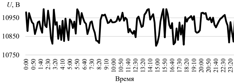
Рис. 2 - График замеров напряжения на шинах ГПП, точка 1
