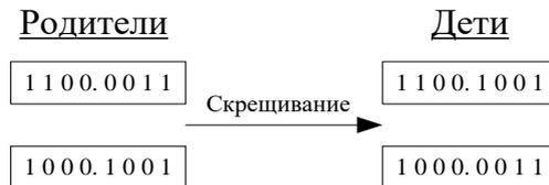
Рис. 3. Процесс скрещивания переменных в двоичной системе исчисления
