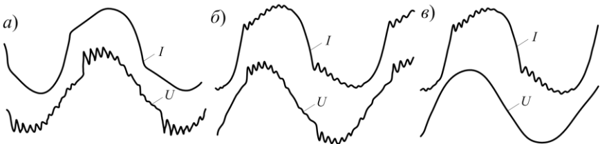
Рис. 3. Ток I и напряжение U в различных точках системы электроснабжения: a – на электровозе; б и в – соответственно на тяговой подстанции и у источника питания
