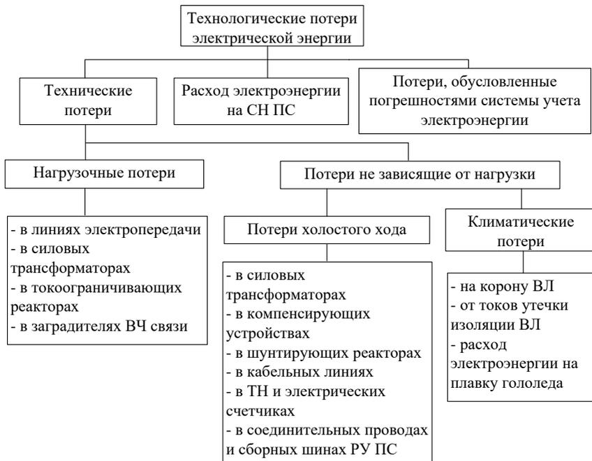
Рис. 1. Структура технологических потерь электрической энергии
