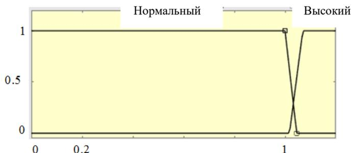
Рис. 2. Функции принадлежности лингвистической переменной «Выходной ток ПЧ»
