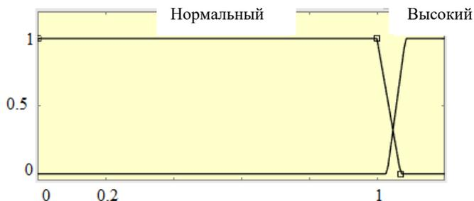
Рис. 3. Функции принадлежности лингвистической переменной «Температура ключей»
