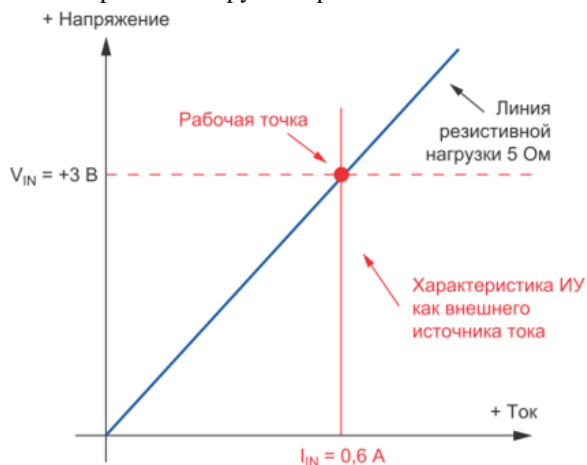
Рис. 6. ВАХ электронной нагрузки в режиме постоянного сопротивления
