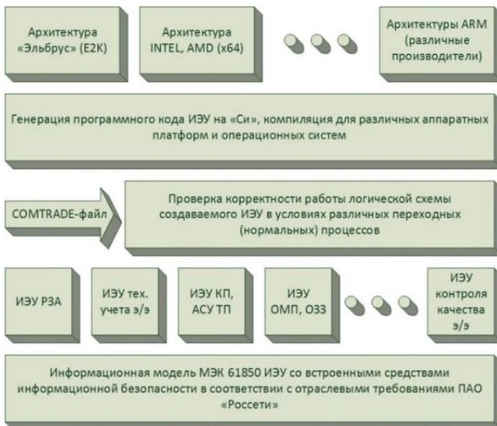
**Рис. 3. Процесс создания кроссплатформенных ИЭУ для ЦПС с интегрированными функциями ИБ**
