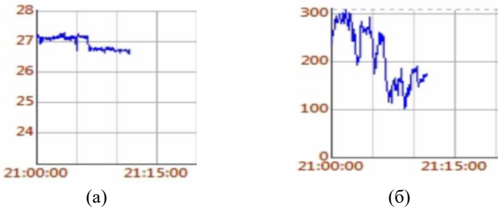
Рис. 7. Напряжение стабилизации СГРМ, кВ (а); ток СГРМ, А (б): ось абсцисс – время в час: мин: сек.
