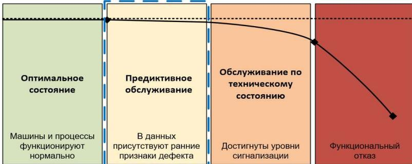
Рис. 1. Место ПД в жизненном цикле оборудования (P-F кривая)
